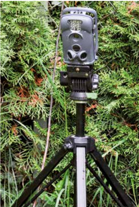
Abb. 1: Einfache, kostengünstige Kamerafalle im Einsatz.
